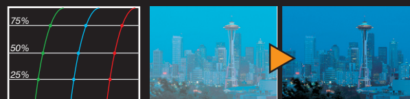
RGB個別にHIGH (75%付近) MID (50%付近) LOW (25%付近) トーンでのガンマ補正が可能
